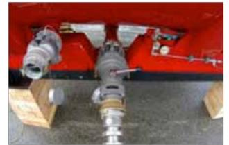
2. Abrir manualmente la válvula de fondo mediante el uso de un tornillo de métrica 10, de al menos 10 cm de longitud (previa extracción del tapón de protección de la rosca). Si no llevamos este tornillo en el material de dotación (a partir de ahora deberemos llevarlo dentro del material de MMPP), podremos encontrarlo:
