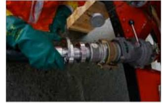
6. Para terminar de vaciar el depósito (posición de gran inclinación), habría que aspirar desde arriba abriendo la tapa de hombre, o desde abajo desmontando la válvula de fondo.
