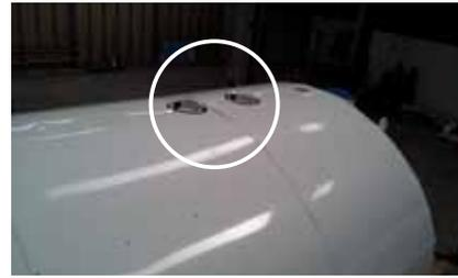
Válvulas de sobrepresión del depósito
