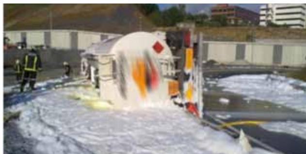
1. Identificar los puntos de fuga y controlar su destino, evitando el alcance a cursos de agua o sumideros mediante barreras de contención y taponamiento.
