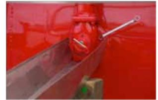
5. Se retira la válvula y por el orificio se introduce una línea de aspiración que nos permita completar el vaciado.
