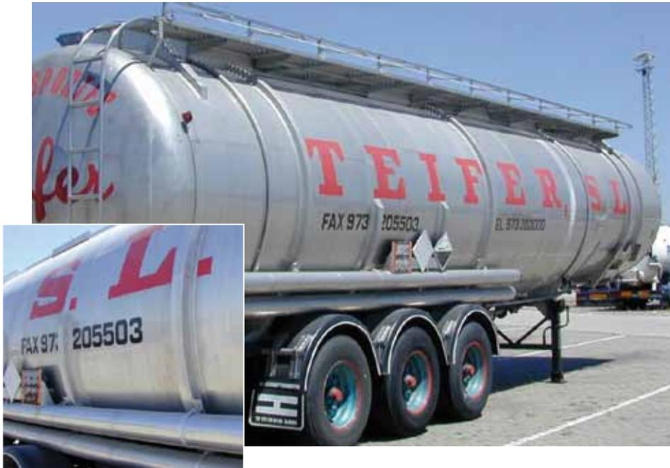
Las costillas pueden ser completas (abrazan todo el depósito) o parciales. En la figura se observan ambos tipos.
