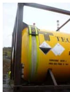
Si la fuga se ha producido por corrosión interna hay que considerar que, allí donde aparece el primer poro el interior está corroído. Si intentamos taponar con una cuña corremos el riesgo de romper la capa exterior, muy debilitada, y ampliar con ello la sección de fuga. Por esta razón la mejor opción, si la situación lo permite, es la obturación con cojines de presión.
