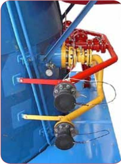
CONEXIONES CARGA / DESCARGA Y VALVULAS DE FONDO
