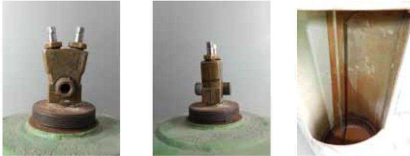
Las válvulas se someten a pruebas de hermeticidad para comprobar la estanqueidad del asiento, sometiendo a pruebas de resistencia aplicando una presión máxima de ensayo equivalente a una sobrepresión del 15% sobre la presión máxima de servicio grabada en la válvula, a pruebas de resistencia a altas temperaturas (a 60°C y hasta 70°C en casos especiales) y pruebas de resistencia a bajas temperaturas (a -25°C y hasta -40°C en casos especiales).
