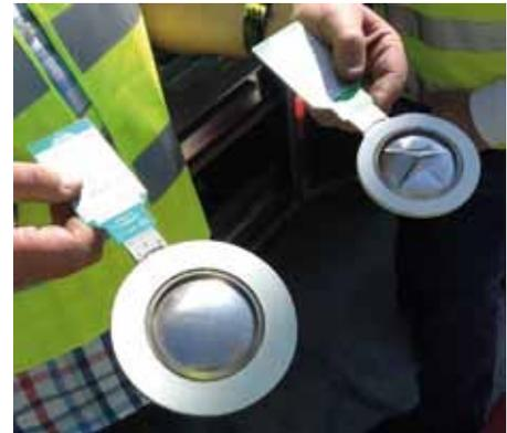
El disco de rotura es una superficie circular metálica, debilitada en 2 ejes, tarada para que rompa a una determinada presión.
