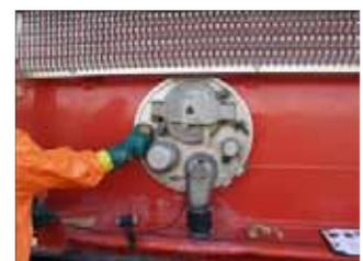
3. En una maniobra rápida retiramos el tapón y colocamos el adaptador a rosca, con válvula de corte en la posición de cerrada. Se pierden pocos cc de líquido.
