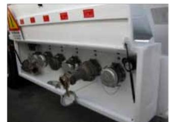
Mientras no accionemos la llave de corte manual, el bulón de la llave de corte no empujará el cierre de seguridad de boca de carga-descarga.
