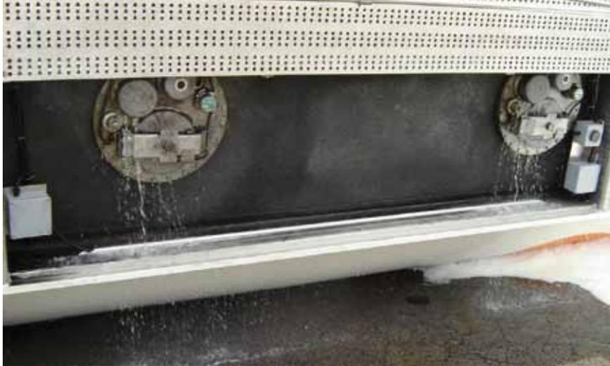
Junto a la boca de hombre de cada compartimento, una válvula neumática comunica su interior con un colector común a todos los compartimentos. El extremo opuesto del colector acaba en un racor tipo API ubicado en el interior del armario de conductos de carga/descarga.
