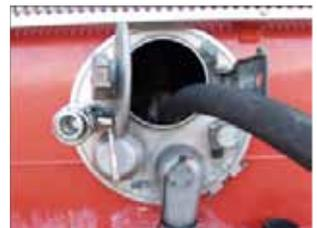
9. Otra posibilidad es a través de la válvula de recuperación de gases, si disponemos del adaptador necesario. Para esto se desmonta el fuelle de goma y se coloca un adaptador y una válvula de corte. Una vez colocados todos los elementos necesarios para el trasvase se procede a la apertura neumática de la válvula de recuperación de gases.
