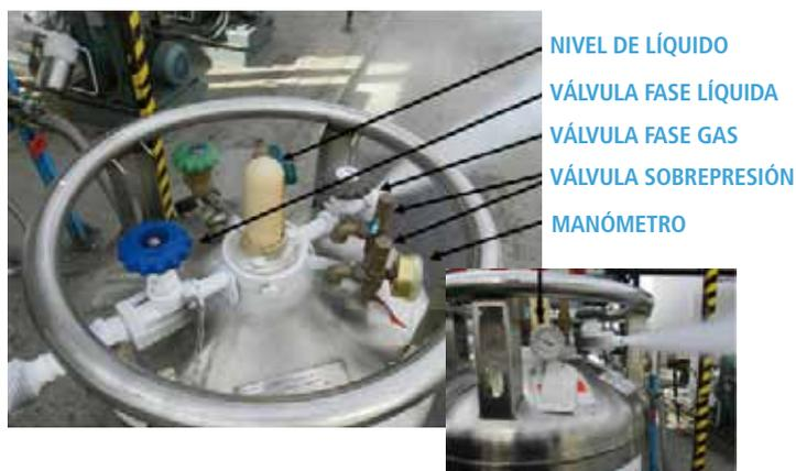
Estos sistemas de seguridad también serán compatibles con el producto contenido y con las bajas temperaturas a que están sometidos. Las válvulas serán del tipo de cierre «deformable», de elevación total y concebidas de forma que el paso a través de la válvula sea superior al 80 por 100 de la sección neta de paso en el asiento.
