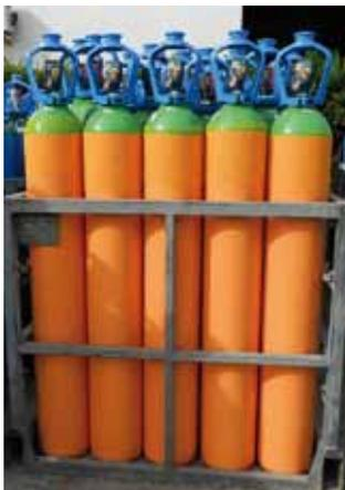
Recipiente con capacidad en agua comprendida entre 1 y 150 litros y destinadas a contener y transportar, a temperatura ambiente, gases comprimidos, licuados y disueltos a presión.
