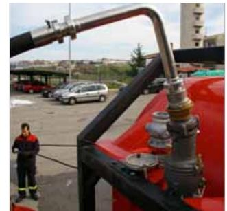
2. Cuando el nivel de líquido alcanza el nivel superior del orificio de salida se rompe la vena líquida y hay que detener el bombeo.
