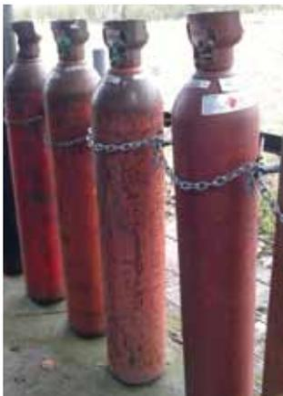
Recipiente provisto de válvula, con o sin dispositivos de seguridad, conteniendo una masa porosa, un disolvente para el almacenamiento de acetileno y una protección de válvula. La botella para acetileno debe estar de acuerdo con el cálculo, construcción y recepción de botellas de acero con y sin soldadura para gases comprimidos, licuados y disueltos a presión.
