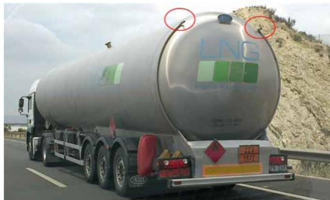
Fig. 7. Apagallamas o dispositivos de venteo en una cisterna para transporte primario aislada al vacío para GNL
