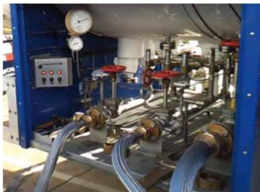
Fig. 18. Conducciones fase líquida y gas para trasvasar con un PPR portátil.
