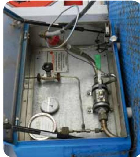
VÁLVULA DE CARGA/DESCARGA CON VÁLVULA DE PURGA
