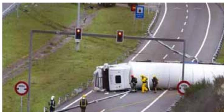
La baja densidad del GNL ( $445,2 \text{ Kg/m}^3$ ), que se transporta a una temperatura de  $-160^\circ\text{C}$ , permite que el volumen transportado de GNL sea grande. La masa usual de carga en las cisternas de transporte primario suele ser de 20000 kg. Esto corresponde a un volumen de 45000 litros, que representa un 85% del volumen total de la cisterna, que es de 54000 litros.
