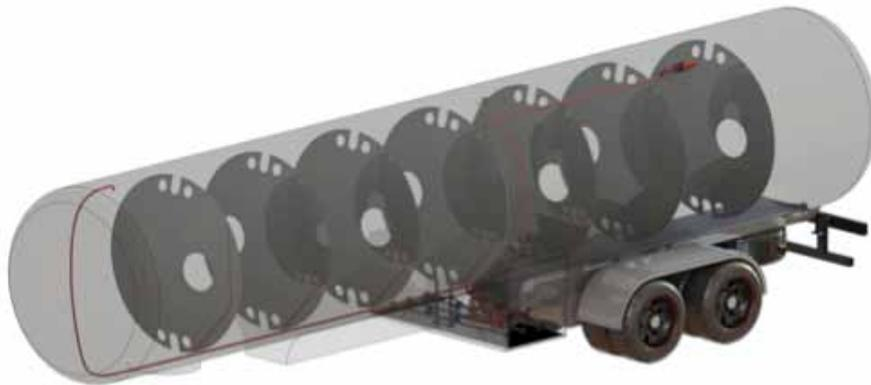
Fig. 5. Circuito de seguridad (en rojo) en una cisterna monocasco para el transporte de GNL
