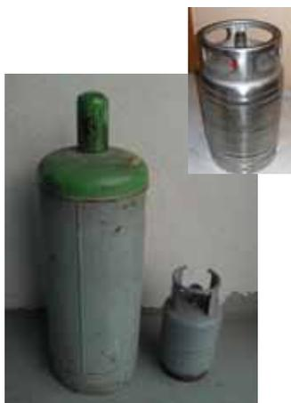
Recipiente cuya presión de prueba no exceda de 60 kg/cm<sup>2</sup>, de capacidad en agua entre 1 y 150 litros y destinadas a contener y transportar, a la temperatura ambiente, gases comprimidos, licuados y disueltos a presión.
