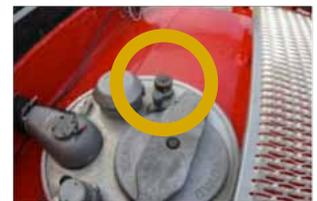
4. Abrir la válvula de descarga y accionar bomba hasta que se vacíe el compartimento, al menos hasta el nivel de la válvula de fondo.
