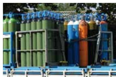
Transportes secundarios: camiones caja fija de diferentes tamaños en los que se transportan bloques, conjuntos, botellas sueltas o armarios.
