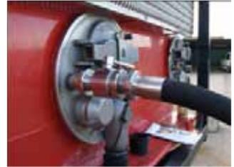
5. Otra posibilidad es vaciar por gravedad. En este caso la entrada de aire y la salida de líquido se producen por el mismo orificio, lo que ralentiza el proceso.
