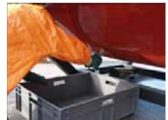
5. Si hay fugas por junta de boca de hombre, válvula de 5 efectos u otro elemento de comunicación, se recogerá el vertido mediante canaletas y depósitos, para evitar que el producto llegue al suelo. Intentar apretar palomillas o tuercas de boca de hombre, u obturar puntos de salida.
