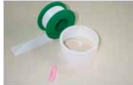
Si la fuga se produce por la válvula de sobrepresión como consecuencia de la rotura del disco, se colocará el CAP o capuchón de seguridad que está siempre en el domo. Se rosca con la ayuda de cinta de teflón para ayudar a la hermeticidad.
