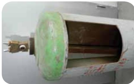
VÁLVULA DE CARGA Y DESCARGA DEL BLOQUE
