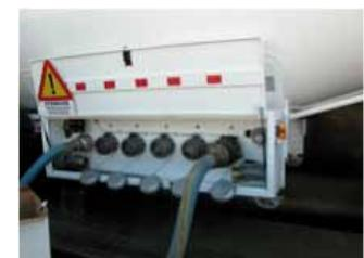
Si se trasvase a otro depósito que no permita la recirculación de gases, abrir el tapón del nivel manual, para evitar vacío y para que no tenga que trabajar la válvula de 5 efectos.
