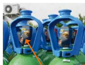
En las botellas de gases a presión se monta una válvula de asiento protegida por la tulipa, en los casos de gas licuado tendremos dos tipos de válvulas en función de la presión a la que se encuentra el gas licuado. Si la presión es elevada la válvula llevará un disco de ruptura como medida de seguridad. Este tipo se monta en botellas de CO2 cuya presión no es tan elevada (80 bar).
