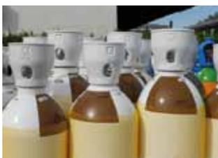
El cálculo del espesor de las partes sometidas a presión en las botellas se realizará en función del límite elástico del material con que se construya, del diámetro y de la presión a la que va a trabajar el recipiente. En cualquier caso el espesor no será inferior a 1,5 mm. para botellas de capacidad igual o superior a tres litros, ni inferior a 1 mm. para botellas de capacidad inferior a tres litros.
