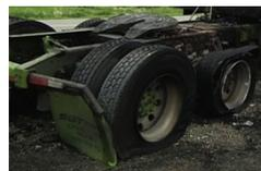
En un incendio de vehículo (especialmente en vehículos pesados y autobuses) el reventón de un neumático puede resultar peligroso para el Cuerpo de Bomberos (ráfagas, proyección de objetos, incidencia auditiva). Especial atención a los reventones de neumáticos "retardados", que pueden suceder después de la extinción completa del fuego del vehículo.
