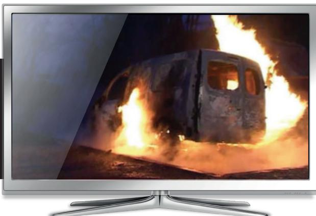
El descontrol térmico de la batería desencadenará la fuga de gases inflamables. El fuego de VeH/VE se parecerá a una fuga de gas en llamas (sin presión).
