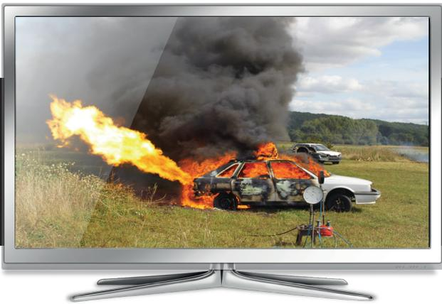
El estallido de la válvula de un vehículo boca abajo producirá una antorcha en fase gaseosa cíclica.
