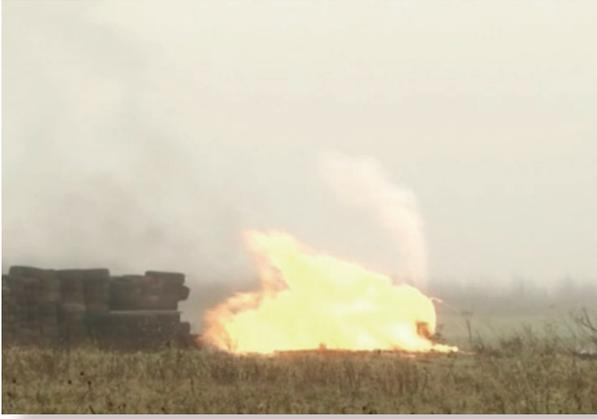
La reglamentación actual no impone de doblar la seguridad sobre un depósito GNL por un termo fusible. Así una degradación de los dispositivos de válvula que permitirá regular la presión podrá provocar una elevación de ésta dentro del depósito con un riesgo de BLEVE.
