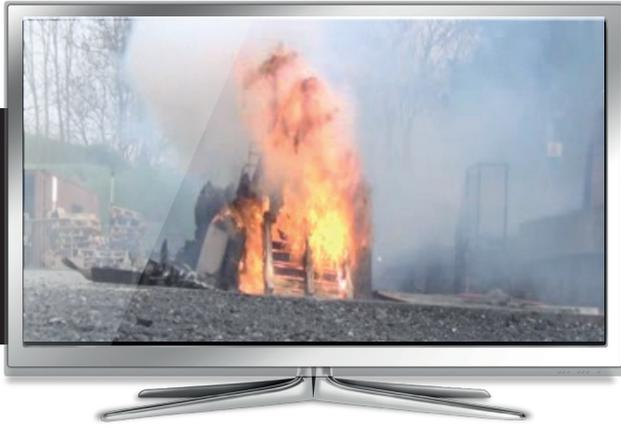
La agresión térmica de una batería LMP se traduce por llamas muy densas con emisión importante de humos, acompañadas por proyecciones de partículas de metal en fusión.
