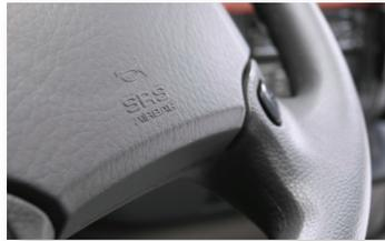
La posición de aproximación de un airbag en el vehículo es reconocible en función del modelo, del marcaje **SRS AIRBAG, AIRBAG, SRP, SIPS BAG, SIR, HPS, IC, WC, RS...** o gracias a la ayuda de un icono situado sobre el salpicadero o el parabrisas.
